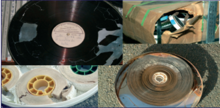
Figura 1. Esempi di supporti deteriorati
