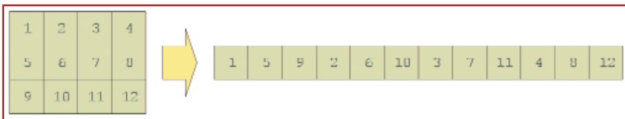
Figura 4. Esempio di allocazione dei valori dei pixel nel file FITS.
