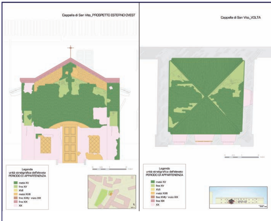
Figura 2. Rappresentazione delle unità stratigrafiche dell'elevato relative alla facciata ovest e alla volta interna (elaborazione: Cristina Monaco, 2008)
