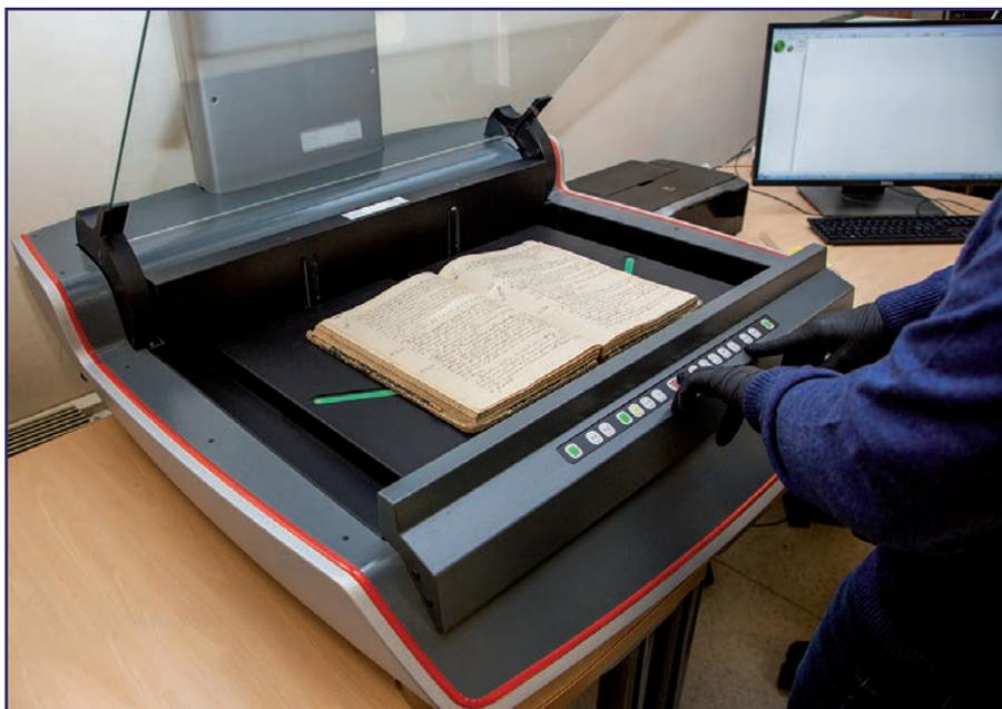
Figura 1. Uno degli scanner planetari utilizzati per la digitalizzazione del materiale presente in archivio
